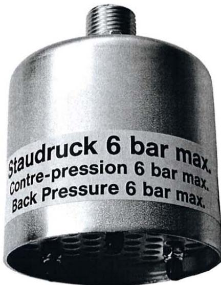
Schalldämpfer dienen zur Geräuschrückbildung an pneumatischen Anlagen. Nach verrichteter Arbeit in geschlossenen Systemen erfolgt das Abblasen grosser Durchflussmengen in die Atmosphäre. Die rasche Entlüftung und die Entspannung auf Normaldruck bei gleichzeitiger Schalldämpfung wird durch die optimale Anordnung der Filzscheiben und Lochscheiben erreicht (Drossel- und Absorptionsprinzip).
