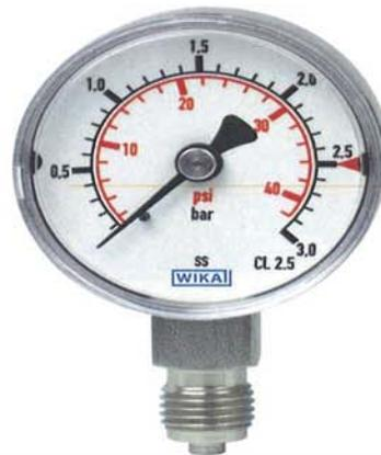
Druckmessgerät mit Rohrfeder Typ 131.11.50 mit
