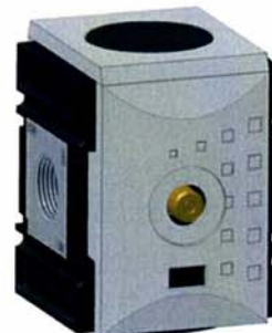
Material: Grivory (PA66) / IXEF1022 Prüfdruck 64 bar = Berstdruck nach ISO 6953
